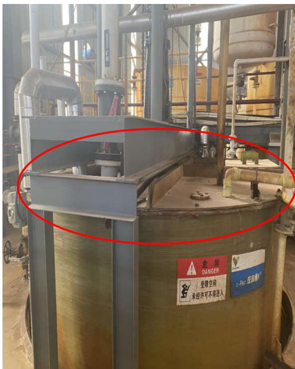
胶体制备桶：反应桶加盖密闭集气
