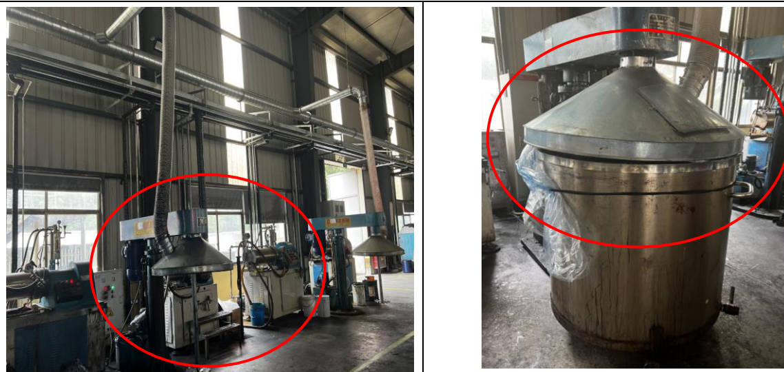
功能性有机颜料分散体--高速分散、调和废气：密闭式集气罩收集
