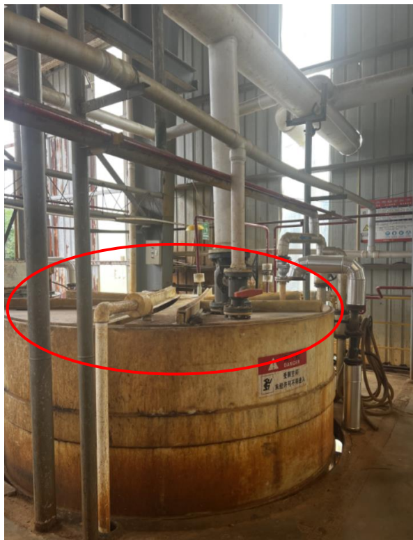
硫酸亚铁制备桶：反应桶加盖密闭集气
