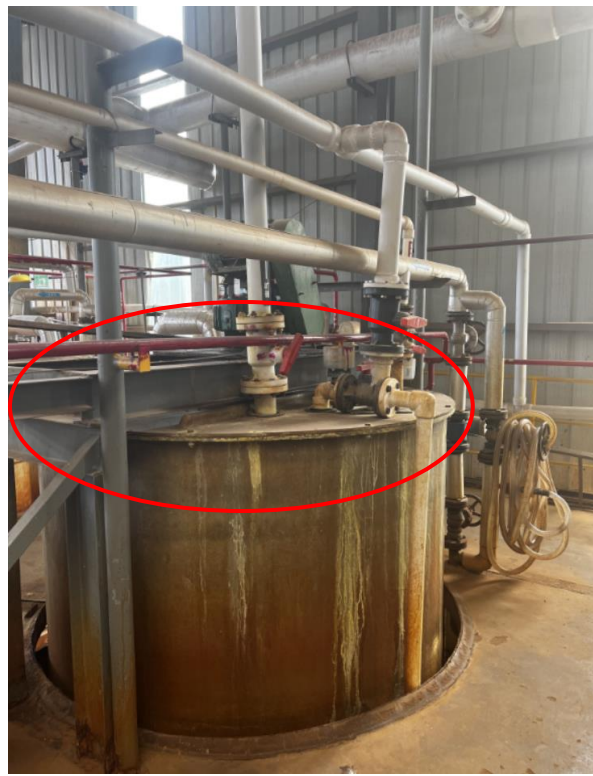
硫酸高铁制备桶：反应桶加盖密闭集气
