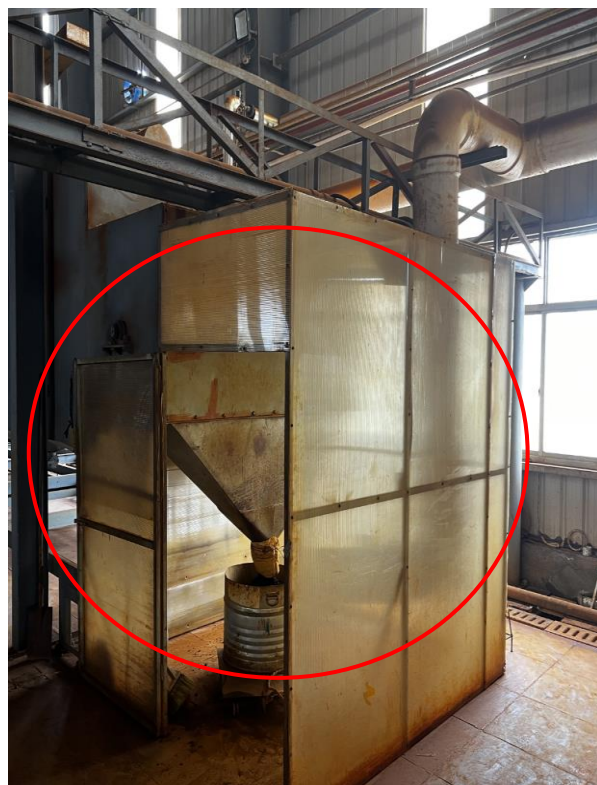
带式干燥后出料：出料隔间+集中抽气
